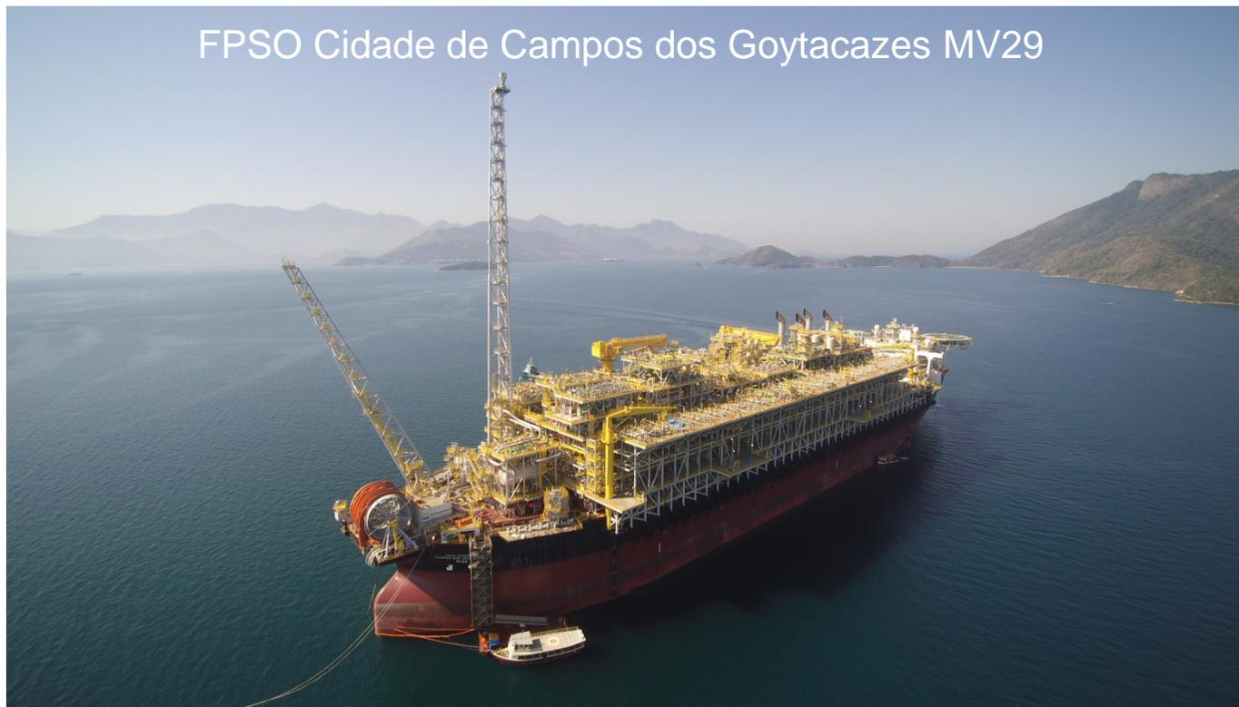
生産設備, 船体設備, 係留設備の3つで構成される
